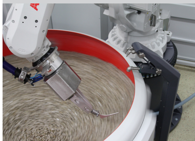
Blick in den Arbeitsbehälter: robotergeführtes Werkstück
