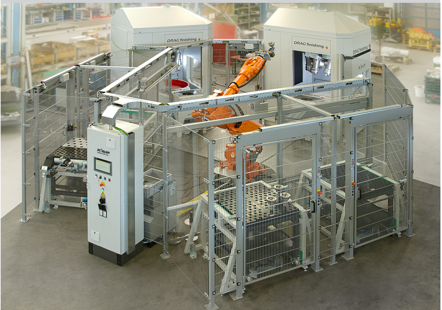
2 Schleppfinishanlagen in Verkettung mit Werkstückhandling über Robotertechnik
